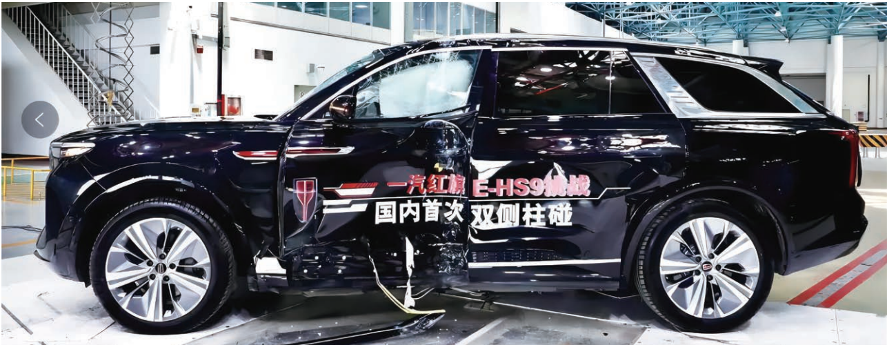
2021年6月，红旗E-HS9在中汽中心碰撞试验室内进行国内首次双侧柱碰公开试验挑战并取得圆满成功
